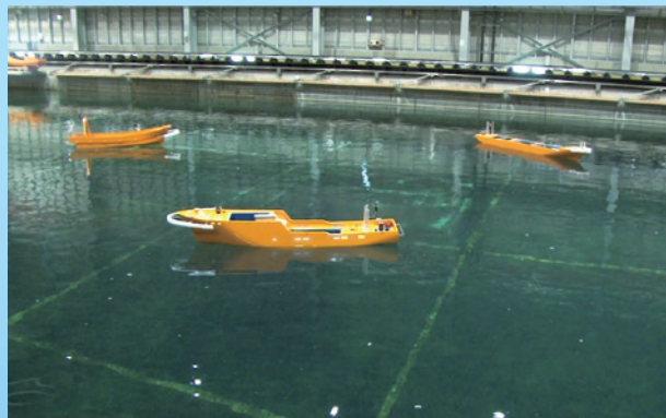
室内の大型水槽で船同士が衝突するのを自動で避ける試験を行っています
