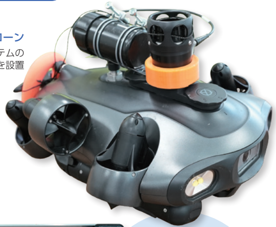
ステレオカメラ用機材 ドローン本体の下部に設置して使用する
