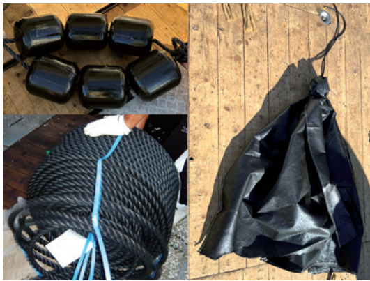
写真 ポリ乳酸(PLA)製のFADs素材 左上:PLA製フロート、左下:PLA製ロープ、 右:PLA製シート
