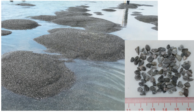
写真1 愛知県三河湾衣崎地区に敷設された碎石(左) (粒径2.5~5.0ミリ程度)とその拡大画像(右)
