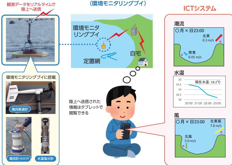
リアルタイムモニタリングブイによる海況「見える化」システム
