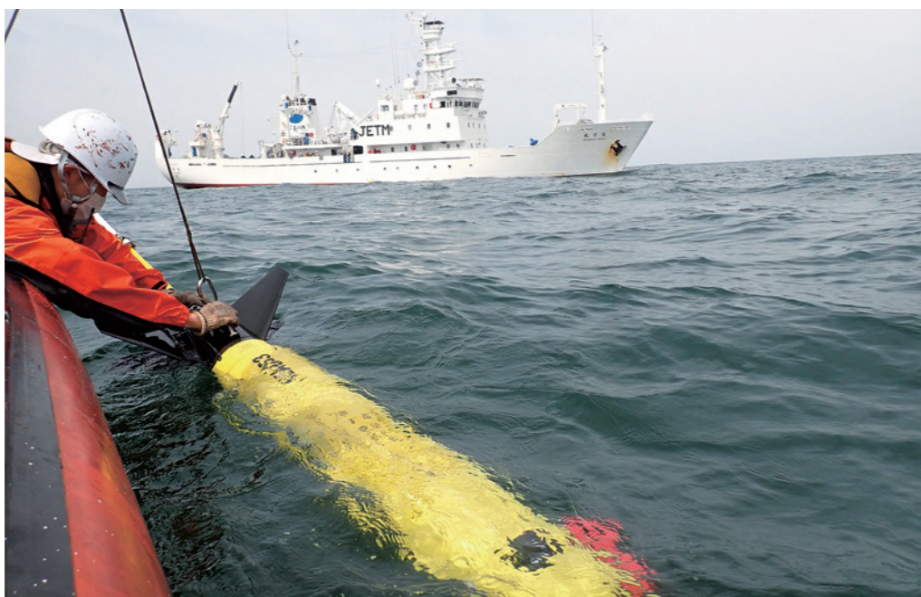
写真 長期運用した水中グライダーを回収 母船の漁業調査船後鷹丸(887トン)からボートを降ろし、水中グライダー(全長約2メートル、重さ約60キロ)を回収するようす
