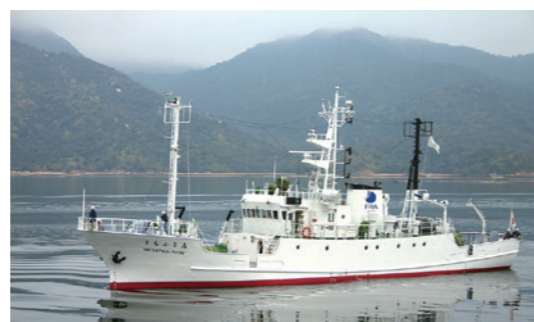
しらふじ丸 しらふじまる 定 係 港 廿日市市(塩屋) 総 ト ン 数 138トン 最大 速 力 12.8ノット 最大 搭 載 人 員 22名
