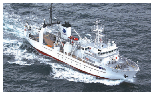
陽光丸 ようこうまる 定 係 港 長崎市(長崎) 総 ト ン 数 692トン 最大 速 力 14.6ノット 最大 搭 載 人 員 33名
