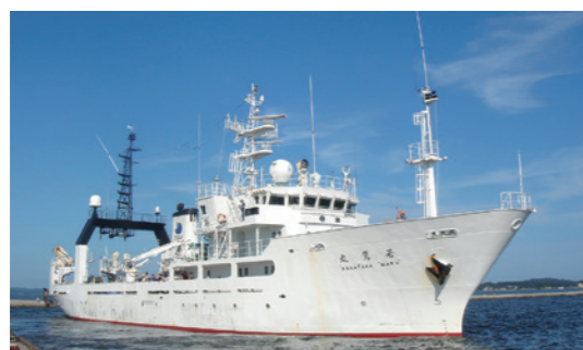
若鷹丸 わかたかまる 定 係 港 塩釜市(塩釜) 総 ト ン 数 692トン 最大 速 力 13.6ノット 最大 搭 載 人 員 33名
