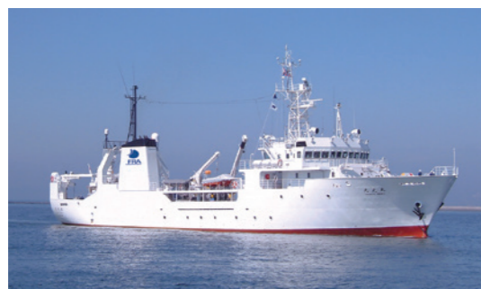
北光丸 ほっこうまる 定 係 港 釧路市(釧路) 総 ト ン 数 902トン 最大 速 力 15.0ノット 最大 搭 載 人 員 37名
