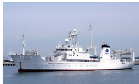
蒼鷹丸 そうようまる 定 係 港 横浜市(横浜) 総 ト ン 数 892トン 最大 速 力 16.5ノット 最大 搭 載 人 員 36名
