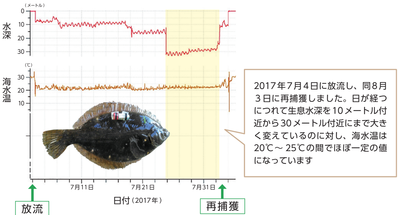
図4 データロガーをつけて瀬戸内海西部に放流し、再捕獲された成魚のロガーに記録されていた水深と水温のデータ
