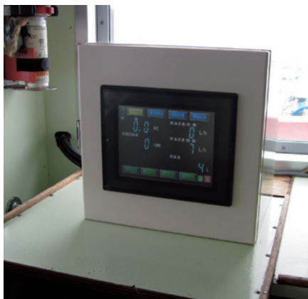
ブリッジに設置された見える化装置のタッチパネルディスプレイ
