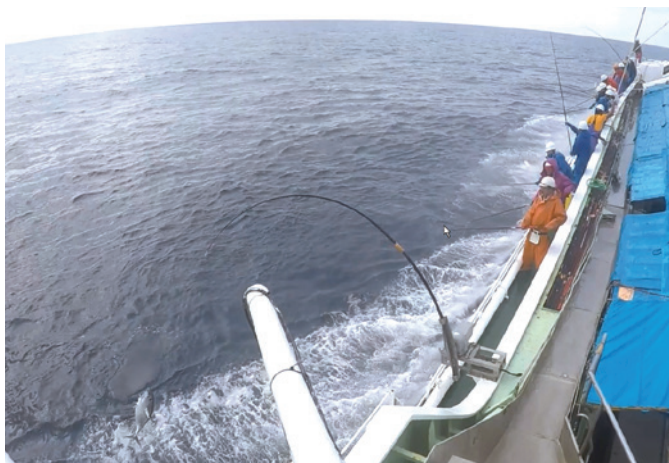
写真1 漁船に取り付けられた試作機 一番手前が試作機。カツオを釣り上げたところ
