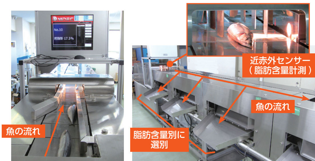
写真3 魚の脂肪含量別選別装置 (株)ニレコと共同開発
