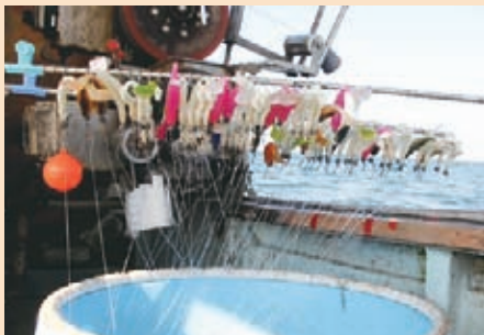
漁業者が考案したものを改良した投縄装置と擬似餌。装置から、枝縄に付けられた針と擬似餌が繰り出される
