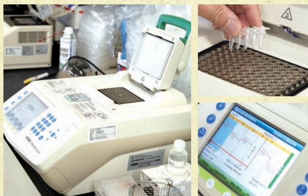
写真2. DNAを増幅するためのPCR機器
