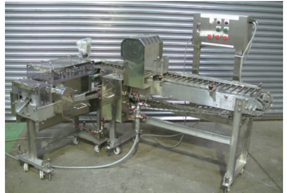
写真1. 小型魚用ヘッドカッター連動型フィレーマシン。
