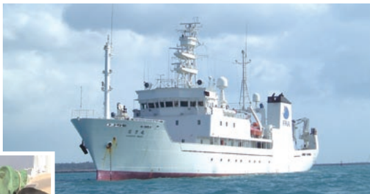
写真1. 調査船 俊鷹丸(総トン数887トン、全長66.31メートル)。鯨類の目視調査に使用する見張り台(海面より高さ17メートル)を有するほか、探鯨ソナーも設置されています。
