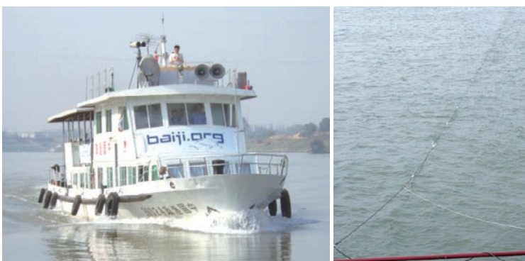
写真3. 航行中の洪湖号（左）と曳航中の水中マイクロホンケーブル（右）。白い点はケーブルを浮かせるための浮力材。
