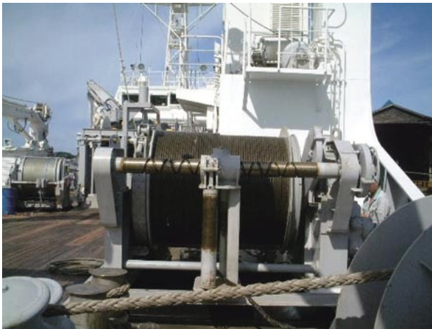
北光丸の自動張力調整機能付きの曳網ウインチ(右舷) 実用性を考慮し、できるだけコンパクトな設計にしてある
