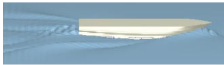
新型船型流れシミュレーション，波形（ランキンソース法） 提供：(有)流体テクノ
