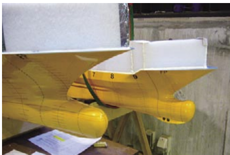
船型模型の船首（奥：在来船，手前：新型船）
