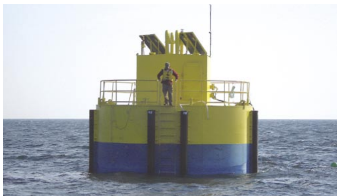
大西洋タラを養殖しているニューハンプシャー大学沖合養殖研究現場。 黄色い施設は自動給餌・管理システム。
