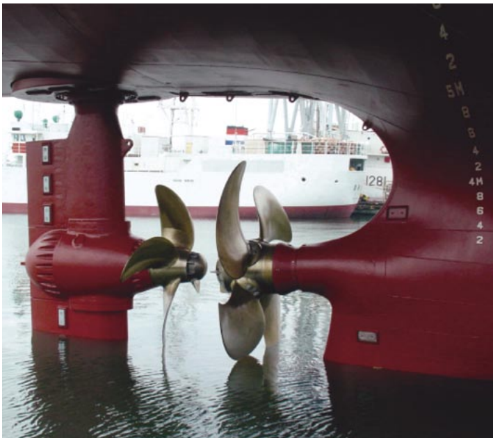
写真2. 二重反転プロペラの推進装置。2つのプロペラを反対方向に回転させることにより、プロペラの後部に発生する渦流のエネルギー損失が少なくなり推進効率が增加する。
