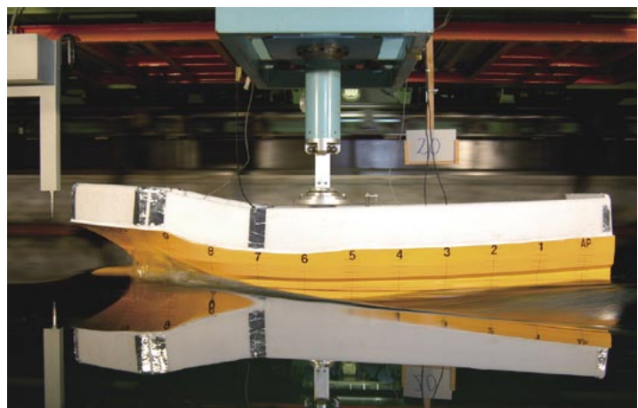
実験の様子（排水量152.7トン，13ノットを想定）
