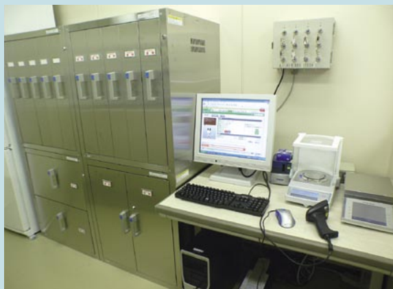
左：試薬保管庫、右：試薬管理システム
