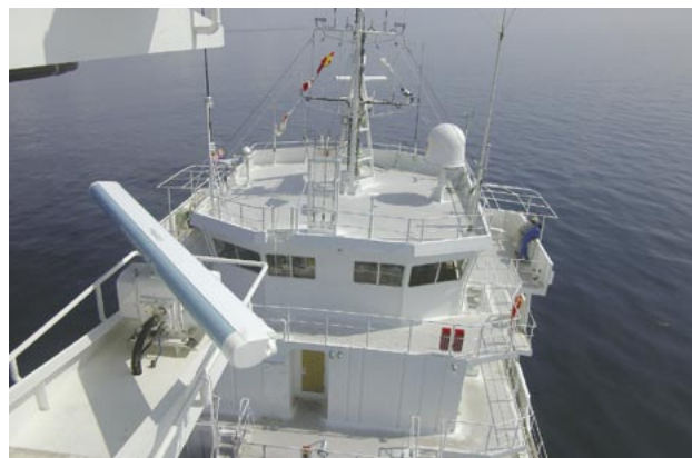
写真3. 全方位視界のブリッジ (船尾側から撮影)。
