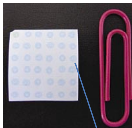
写真1. DNAチップの一例。このDNAチップには、魚類病原細菌に特異的なDNA配列が貼り付けてある。スポット位置の目安に色素を混ぜてある。
