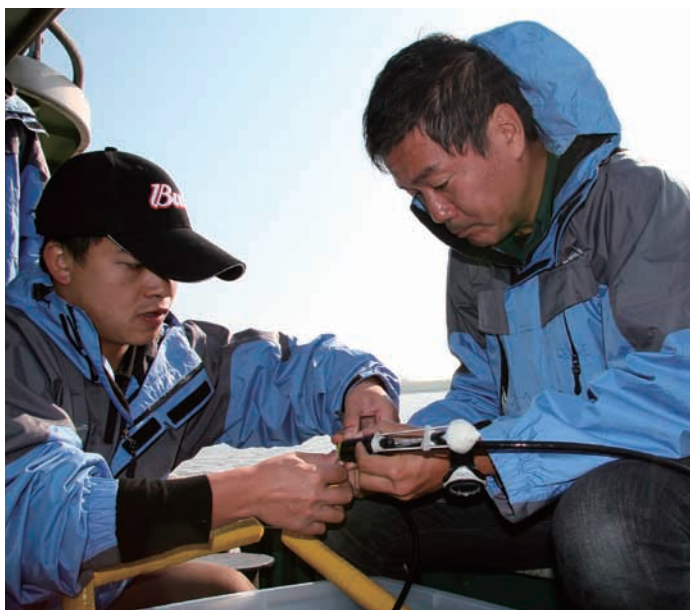
中国・揚子江でスナメリやヨウスコウカワイルカの生息調査を行うためにデータロガーをセッティングする赤松さん(右)
