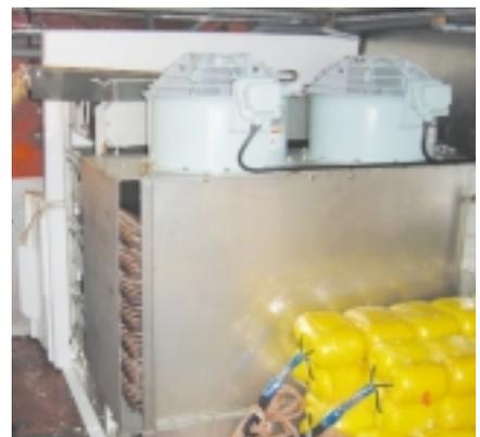
衝突噴流方式のロイン凍結装置
