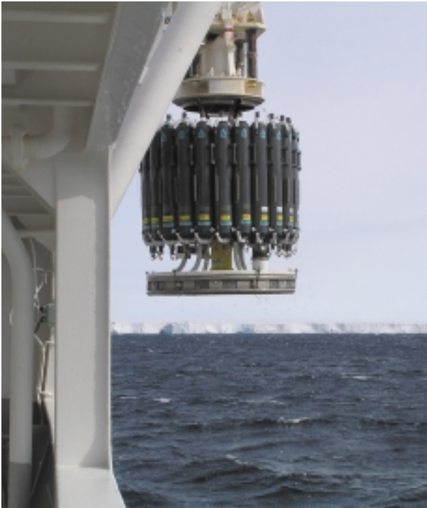
写真5：南極ロス海の最南端における水深別水温・塩分観測とニスキンボトルでの各層採水
