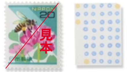
写真1：魚介類細菌性疾病診断DNAチップ（右側） ナイロン膜の基板に病原細菌の特徴的遺伝子が貼り付けてある。切手と比べてると小さいことが判る。
