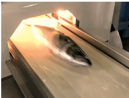
写真2 ライン組込型装置を用いたマサバの計測
