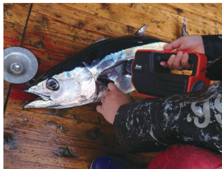
写真1 ハンディ型装置を用いた洋上でのビンナガの計測
