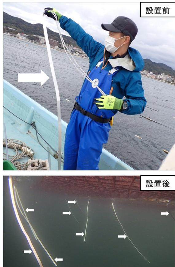
写真1. 試験場所への設置前と設置後の金属板（矢印）、いずれも2022年11月30日撮影
