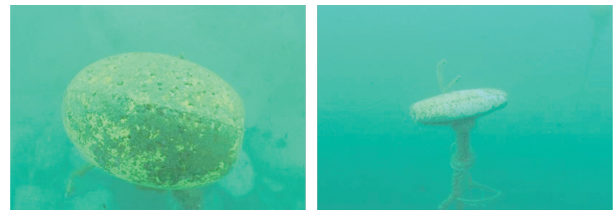
写真 1. 中層に設置されたフロート フロートの長さおよび最大径は、180mm と 142mm (左)、220mm と 52mm (右) (2017 年 9 月 25 日撮影)
