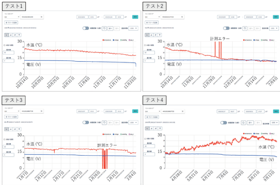
図 3. 海上作動テスト時にSORACOM Harvestに送信され、可視化された水温および電圧のグラフ
