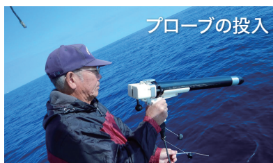
写真3. 宮崎県漁船での簡易型XCTD観測装置による観測試験風景
