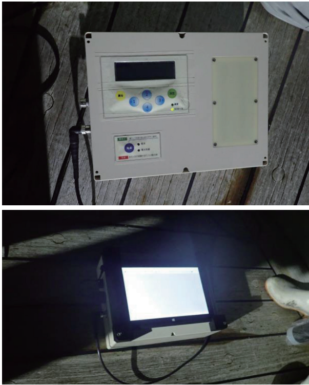
写真1. 2018年7月に製作された2種類の簡易型XCTD観測装置試作機 上が簡易操作型, 下がタブレットPC型
