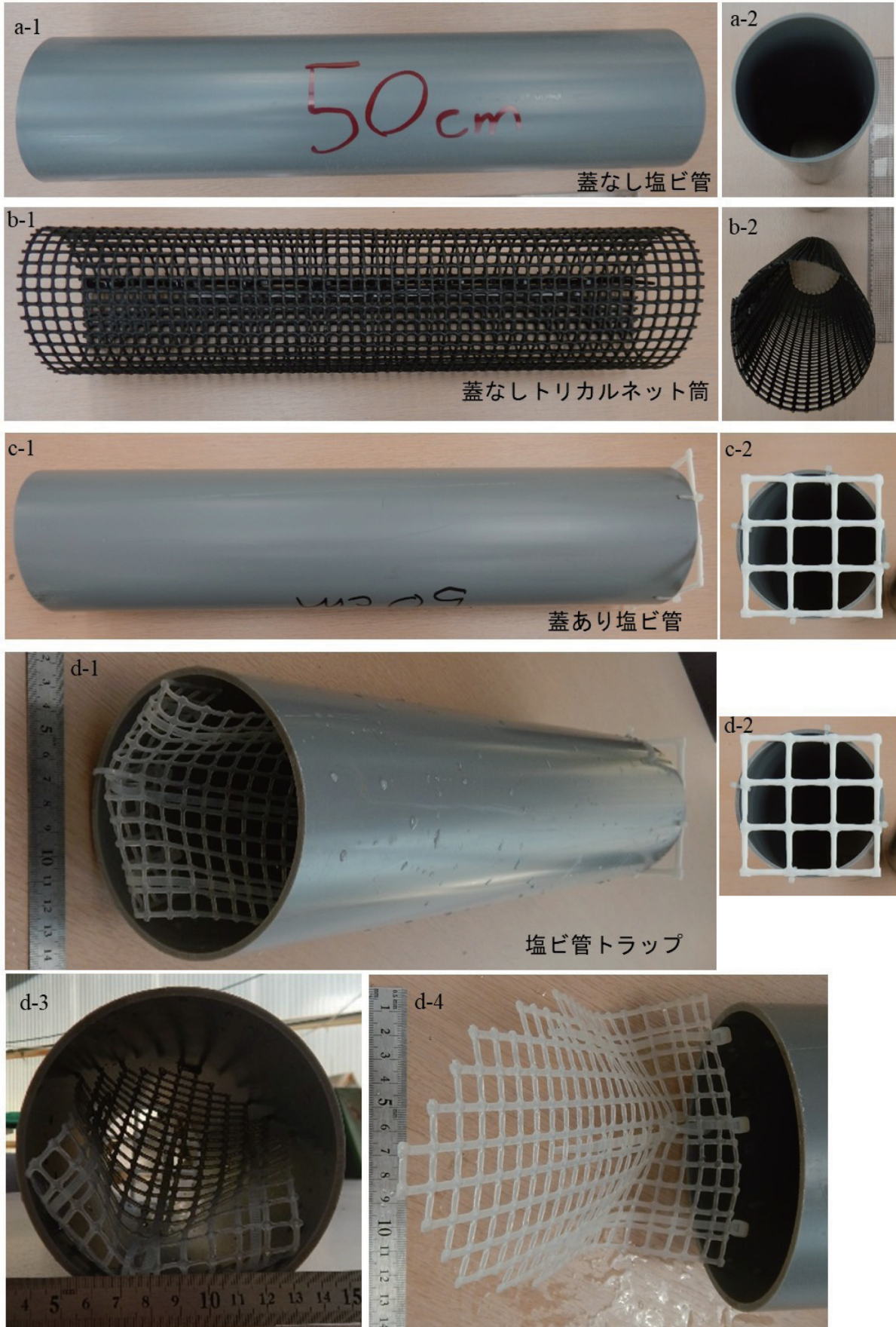
写真1. 実験に用いた各種筒, および塩ビ管トラップ
