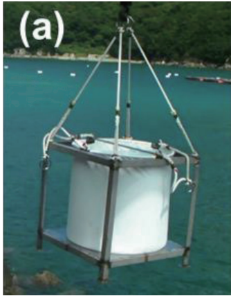
写真1. (a) キャンバスシート製バケツ (直径80cm, 深さ80cm, 容量400L), (b) ターポリンシート製担架 (長さ80cm, 深さ35cm)
