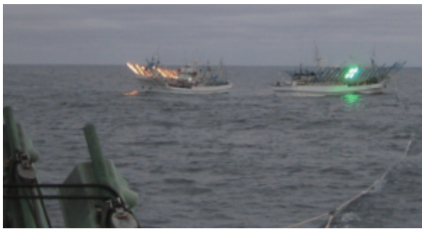
写真1. 敷網方式の洋上転載 裏漕船の船尾方向を撮影（図1参照） 右が裏漕網を取付けた操業船の右舷側（緑色漁灯点灯）、左が運搬船の左舷側
