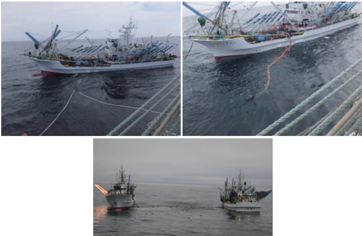
写真4. フィッシュポンプ方式による洋上転載 左上：操業船から運搬船への2本のもやい綱を渡す過程 右上：運搬船からフィッシュポンプホースを受け取る過程 下：操業船(右)から運搬船(左)へ転載中
