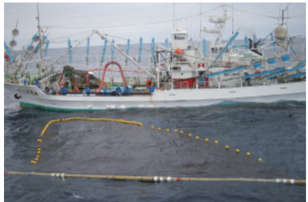
写真2. 敷網方式で使用した転載用敷網 操業船から運搬船を撮影
