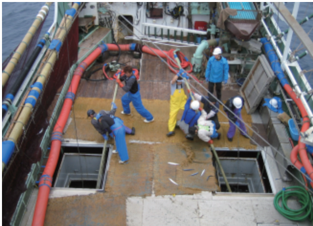
写真3. 敷網方式による転載作業（操業船側） 左：タモ網による魚倉からの漁獲物すくい揚げ作業 右：タモ網による敷網への漁獲物移送
