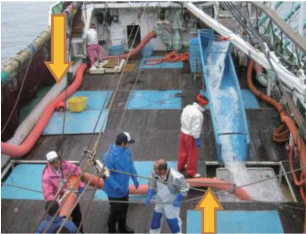
写真5. フィッシュポンプ方式の転載作業（操業船側） 運搬船から受け取った転載用ホースの吸引口を魚艙に入れ漁獲物を転載（右下矢印）、同時に給水用ホースで海水を汲み上げ（左上矢印）注水することで魚艙内の漁獲物と海水の割合を一定に保持した
