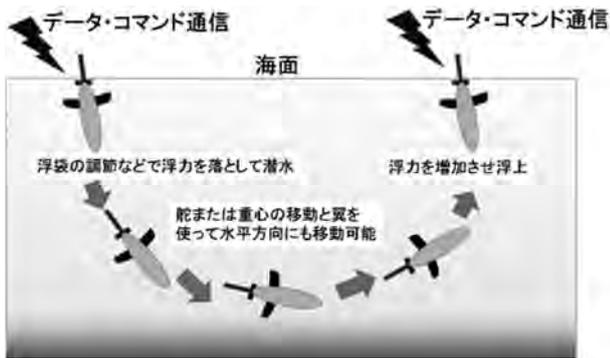
図1. 水中グライダーの移動とデータ・コマンド通信を表す模式図
