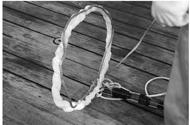
写真6. 若鷹丸の舷から Seaglider にロープをかけるため工夫された回収用棒
