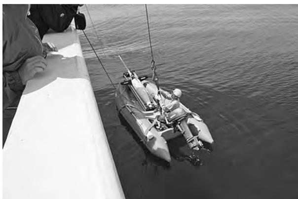
写真 3. ゴムボートを用いた Seaglider の投入 (若鷹丸より 2012 年 6 月)
