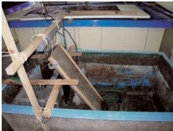
写真1. よじ登り試験水槽とコンクリート板
