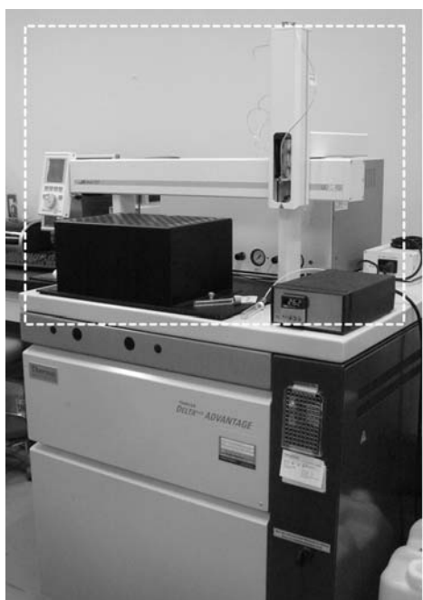
写真1. 連続フロー型前処理装置 GasBench II と質量分析計 Delta plus Advantage の配置 北海道水産研究所内で撮影 左図点線内が前処理装置、その下は質量分析計 右図 (A) ガスクロマトグラフ、(B) オートサンプラー、(C) 恒温槽
