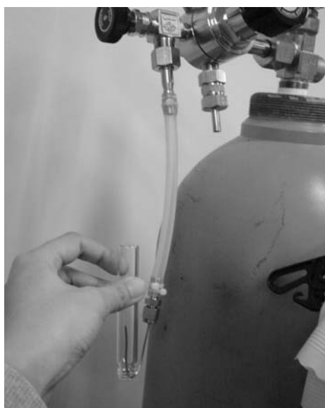
写真 2. \delta^{18}\text{O} 分析時の \text{He-CO}_2 混合ガスによる上方置換ガスポンベの首部から延びる金属管の先端にバイアルを被せ、20 秒置換の後にバイアルの口を下にむけたままキャップを締める
