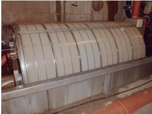
写真 4. デンマークのウナギ陸上養殖場の閉鎖循環システムのドラムフィルター HYDROTEC 社の製品で円筒形ドラムにフィルターエレメントが設置されている構造
