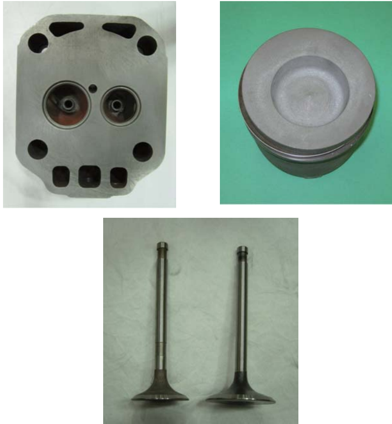
写真4. 耐久試験前シリンダヘッド・ピストン・吸排気弁
