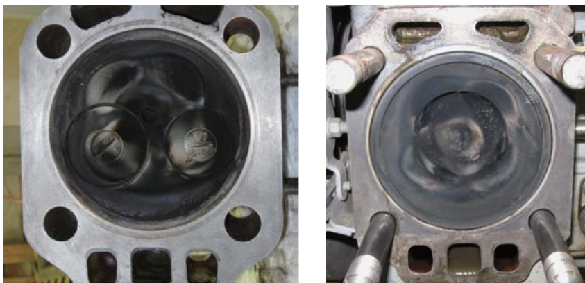
32時間耐久試験後(混合油 10wt/%使用)
