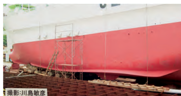
図2. 新しいビルジキール（横揺れ防止の性能を損なわない省エネ型を開発しました）
