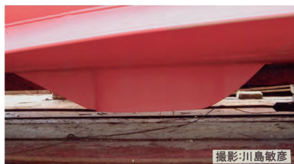
図1. 新しい魚探カバー（魚探の性能を損なわない省エネ型を開発しました）
