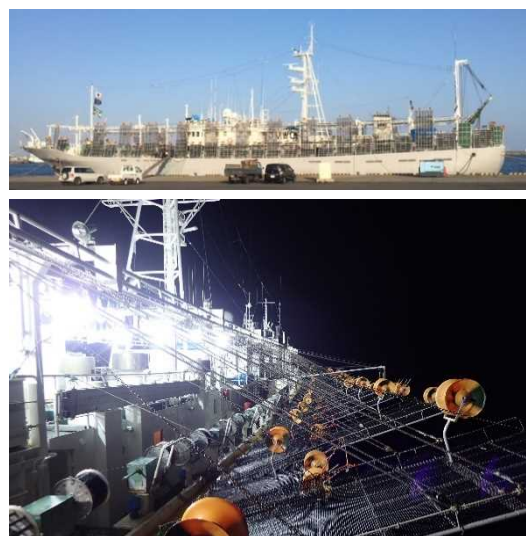
図2. 調査で用船した大型いか釣船「第三十開洋丸(349トン)」(上)と、自動いか釣機による調査風景(下)
