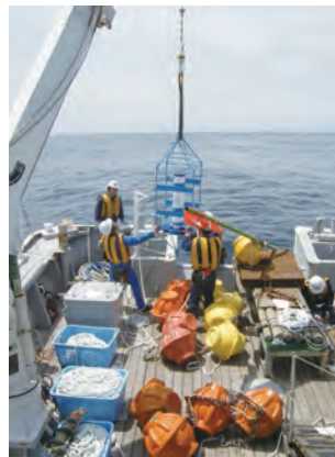
調査船による係留系設置作業
