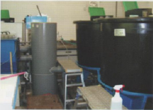
写真4：循環式飼育水槽で排せつ物の流出も無い
