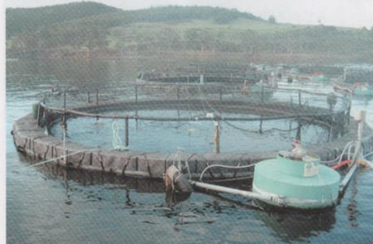
写真8. タスマニアのホバート近郊にあるアクアタス社の養殖場にて。一見円形の生け簀のようであるが、実際はコンピュータ制御による閉鎖循環システムであり、超大型飼育水槽と言った方が適切かも知れない。
