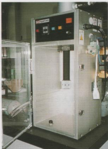
写真1：ヘリウムガス圧方式閉鎖型パーティクルガン。装置の中の黒い筒が銃身。
