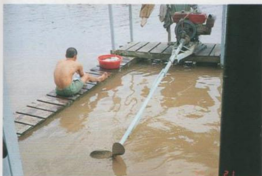
写真3. 乾期の低水位時に酸素不足の緩和に用いる曝気用スクリー。(Angiang 省)
