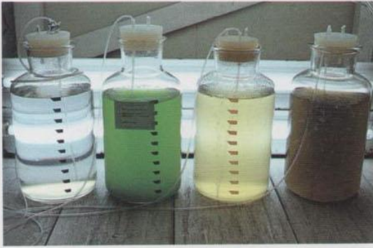
図2. 微細藻類の中規模培養の例。左は10ℓ瓶で培養中のドナリエラ（左）とキートセラス（右）で、共に浮遊性種。右は付着性種の中規模培養のために試作した付着器。
