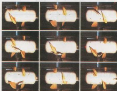
写真Ⅱ. TYPE 3 (2段ランナ)75°-60°107rpm, V60Sec シャッター Shutter Speed separated blade type runner
