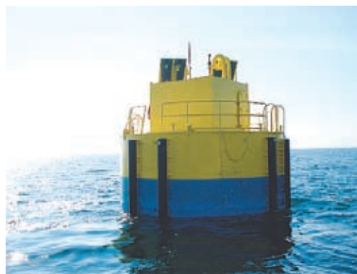
写真1. 沖合養殖用集中管理自動給餌ブイ。ディーゼル発電と太陽光パネルで稼働。
