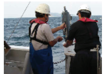
漁業調査船しらふじ丸を利用した海洋調査（ニスキン採水器による海水採取）
