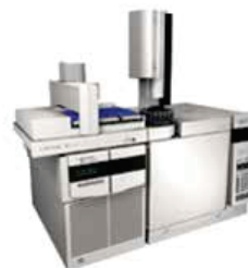
ガスクロマトグラフ質量分析計 (微量な化学物質の分析に使用する)
