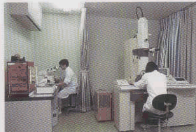
ウルトラマイクローム(左)と透過型電子顕微鏡(右)。海産生物の細胞内微細構造を調べる上で不可欠な装置である。 A transmission electron microscope.
