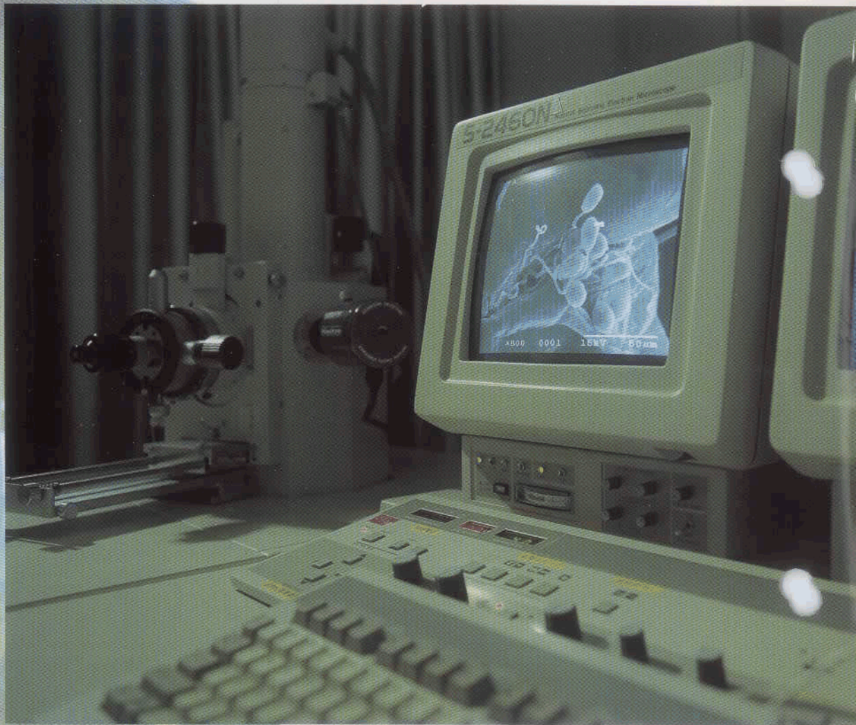
さまざまな海産試料は、最新鋭機器により詳細に解析される。写真は走査型電子顕微鏡。(画面は、小型甲殻類の一種であるアミの体表に外部寄生する繊毛虫の拡大像。) A scanning electron microscope.
