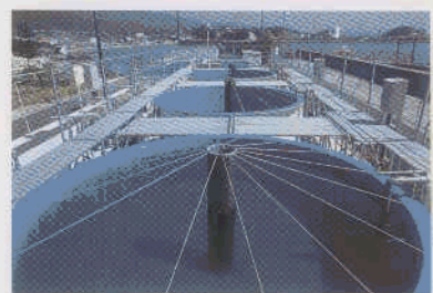
海産生物の飼育に使用される大型水槽。常時、5.0 m沖合いの底層から新鮮な海水が供給されている。 Test tanks.
