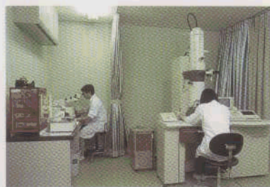
ウルトラマイクローム(左)と透過型電子顕微鏡(右)。海産生物の細胞内微細構造を調べる上で不可欠な装置である。 A transmission electron microscope.
