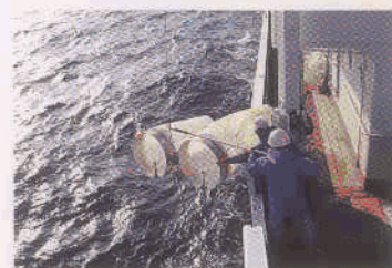
プランクトンネットによる魚類卵稚仔、餌料プランクトンの採集 Sampling of plankton, eggs and larvae using a Bongo net.
