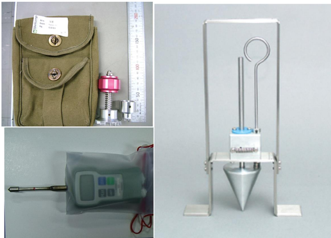
写真2 海の底の硬さを測るためのいろいろな機械
