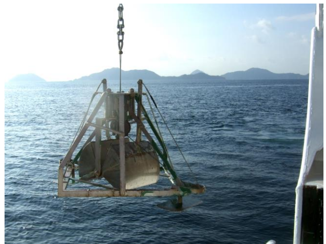
写真 2. SM 採泥器をワイヤーで海中に入れる様子 （口が開いています）
