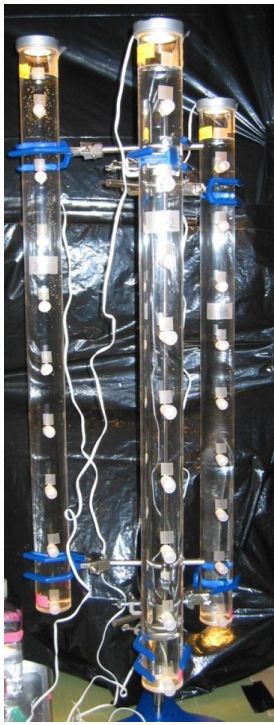
写真2. 日周鉛直移動を観測するための円柱水槽
