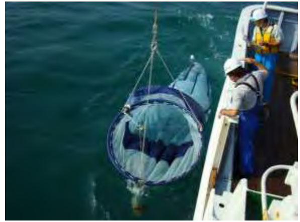
写真4. ORI ネットを引き上げる作業
