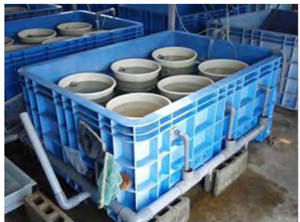
写真 1. 高密度、高生産、高成長、メンテナンスフリーの稚貝育成用アップウェリング水槽
