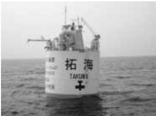
図5. 通常運転状態における「拓海」、上部デッキに気象・海象観測用の機器を設置
