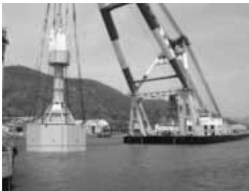
図2. IHI マリンユナイテッド相生工場における肥沃化装置「拓海」の着水作業
